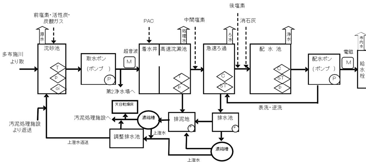
図-2 神野浄水場の処理工程図
