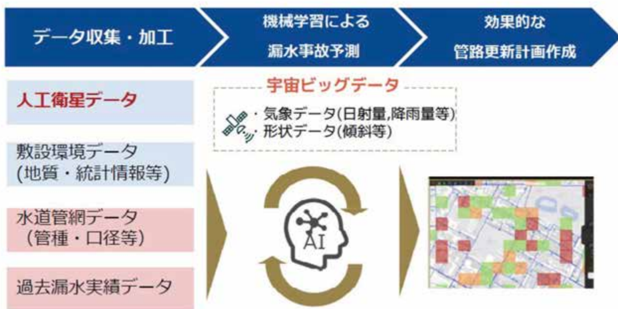
図 48 人工衛星データ・AI 等を活用した管路劣化診断の例
