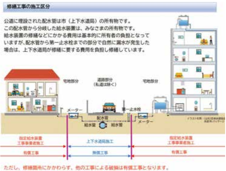
図42 修繕工事の施工区分イメージ
