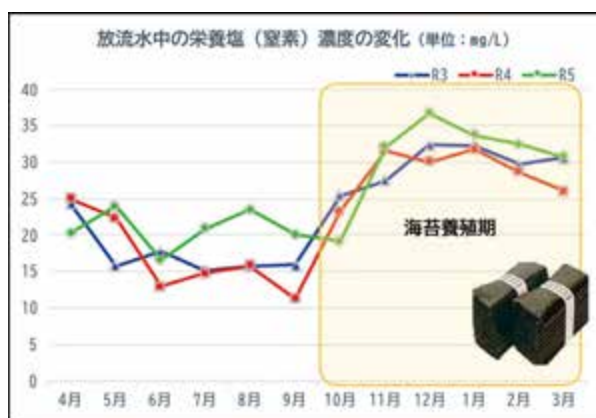
図46 季別運転による処理水中の栄養塩（窒素）濃度の変化
