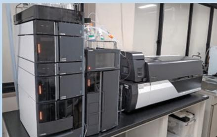
水質検査機器(農薬類等を測定します)
