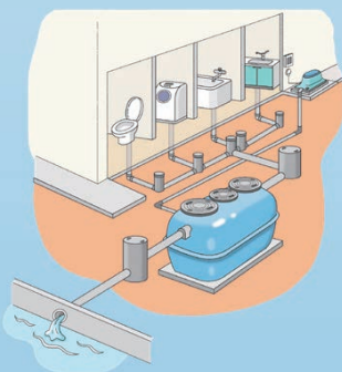
排水設備工事 建物外の排水管や 汚水桝の設置工事
